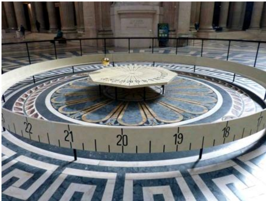
El péndulo de Foucault en el Panteón de París, proporcionó una demostración dramática de que la Tierra gira en su eje.
